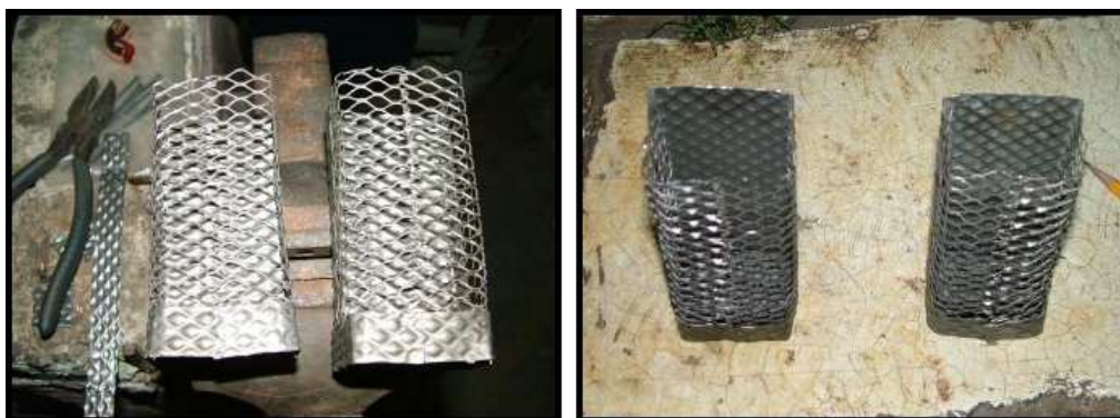
Figura 2.8. Canastillas de titanio
